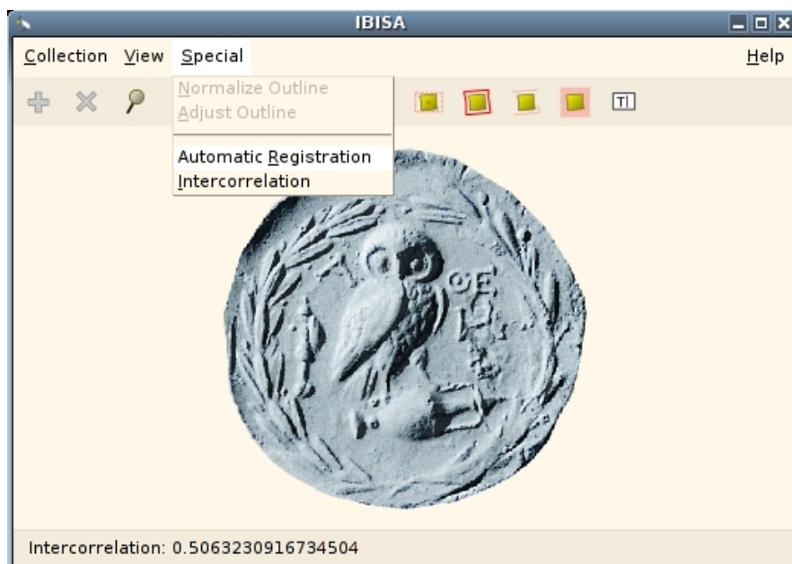
FIG. 11 – Logiciel IBISA (7/7) : Mais le plus sûr moyen d’obtenir de bons résultats et de passer par un algorithme de recalage automatique, disponible dans le menu de l’application. Pour cela, le logiciel Octave est appelé. Cette méthode permet à un spécialiste de modifier directement le code Octave de l’algorithme de recalage pendant que l’application IBISA fonctionne et, par conséquent, d’expérimenter ces changements de manière interactive.
